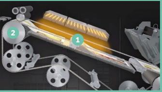
1 Erwärmung per Ferninfrarot strahlen 2 Niederdruck-Fixierwalze
