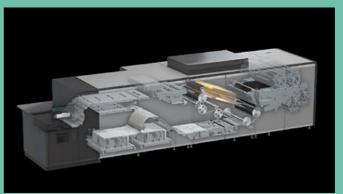
Gerade Papierführung sorgt für einen stabilen Lauf und reduziert die Belastung
