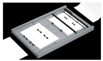
Ein Sensor erkennt eine Fehlausrichtung und die Registrierungswalze korrigiert
