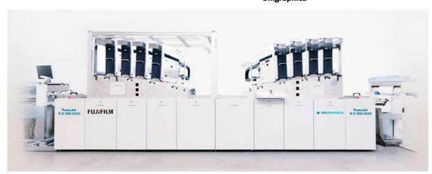
Konfigurierbare Vierfarb-Duplexdruckmaschine von Fujifilm Unigraphica
